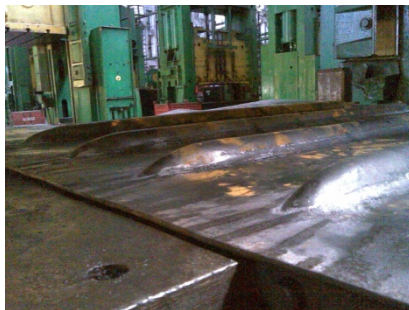
Рис. 1. Отштампованная крышка люка грузового вагона
