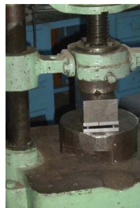
Рис. 5. Оснастка в собранном виде, установленная на прессе
