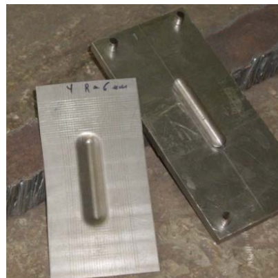
Рис. 3. Пуансон с вкладышем и деформированная заготовка
